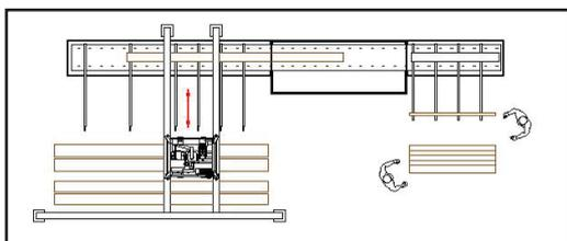
Exemple de dépileur/empileur permettant le chargement et le déchargement de centre d'usinage
