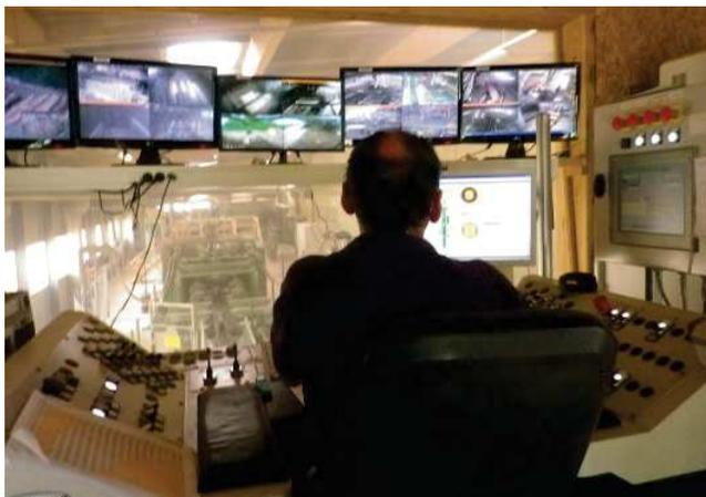
Un opérateur expérimenté toujours là sur une ligne canter, afin de reprendre la main en cas de défaillance du système informatique.
