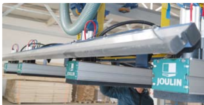
Chwytniki pokryte pianką nie uszkadzają desek czy całych warstw i nie pozostawiają na nich jakiegokolwiek śladów.
