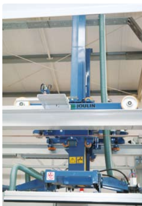
Wszystkie ruchy chwytaków są zaprogramowane i dostosowane do zmniejszającej się wysokości stosu rozkładanego i zwiększającej się stosu układanego.
