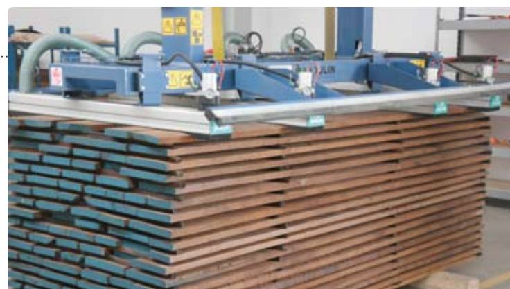
Ramię z czterema podciśnieniowymi chwytakami automatycznie opuszcza się na warstwę desek.
