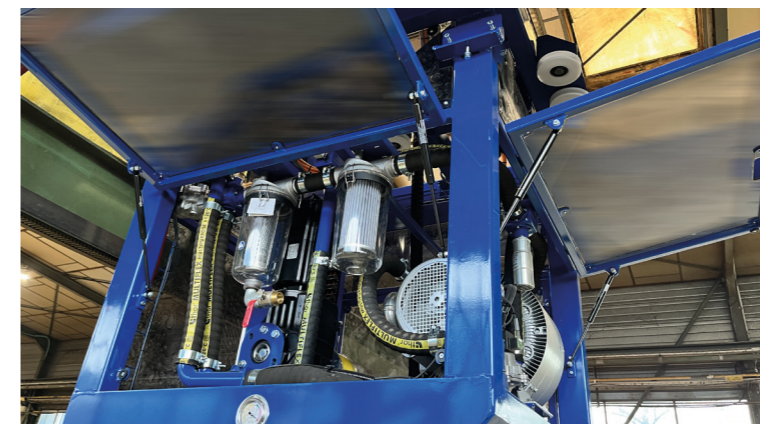
4 portes avec vérins pour maintenance simplifiée
