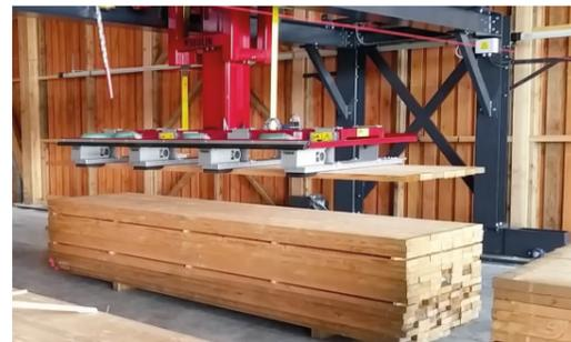
Apilador de 500 kg sobre estructura móvil.
