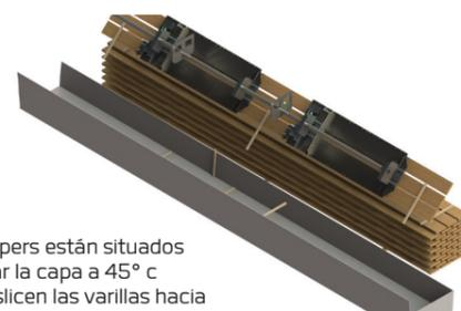
D. Variante de la versión C. Los grippers están situados entre las varillas y pueden inclinar la capa a 45° con el objetivo de dejar que se deslicen las varillas hacia un contenedor.
